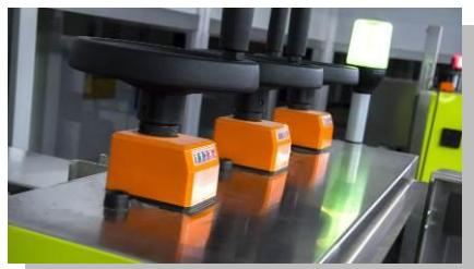
El sistema está concebido para que permita identificar elementos extraños en líneas de embotellado, especialmente en aquellas líneas en las cuales por la tipología de producto o el color del producto envasado, no es posible visualizar si contiene algún elemento en su interior.
