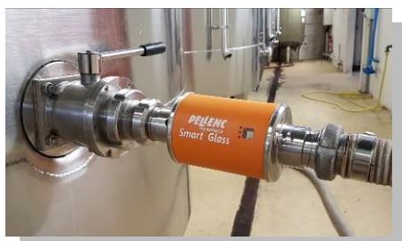
Smart Glass es un sensor inteligente y conectado para el control automático del trasvase de líquidos.
